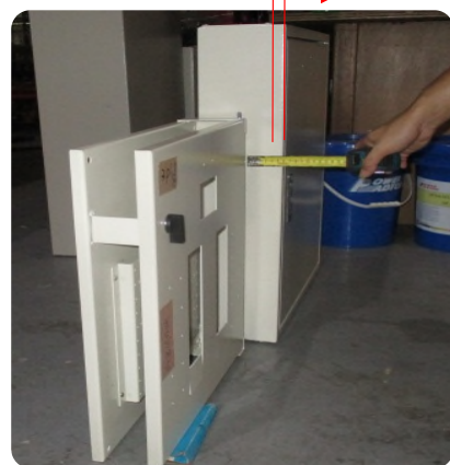
配電裝置或用電設備 突出於安裝面板 > 48 mm
